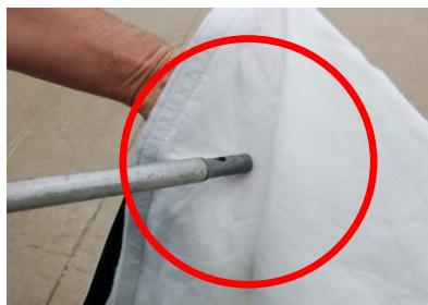
MÅ KUN RENSSES LET MED KOMPRIMERET LUFT UDFRA OG IND. HOLD DYSEN 15-30 CM FRA STOFFET
